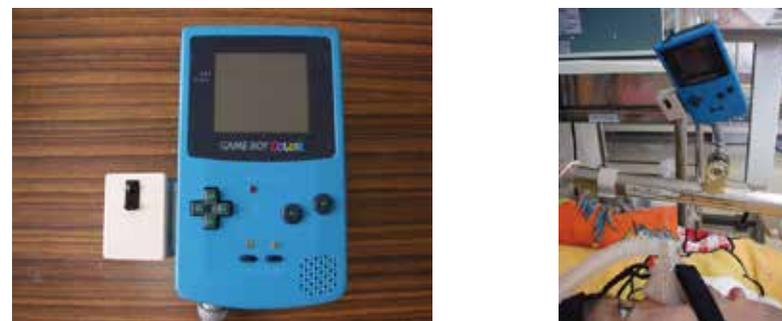
写真8 スwitchで操作できるように工夫された携帯ゲーム機
