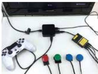
写真 21 コンバーターの活用によりスイッチでゲーム操作が可能に
